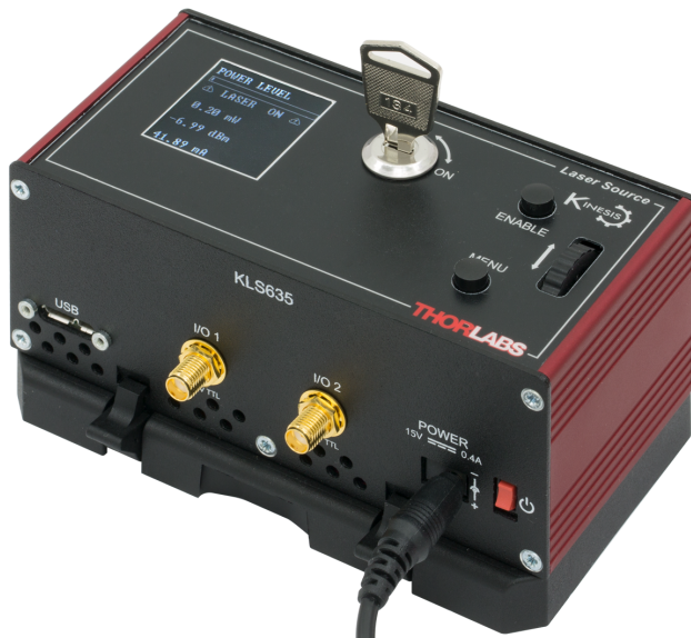
Fig. 1.1 K-Cube Laser Source (KLS635)
